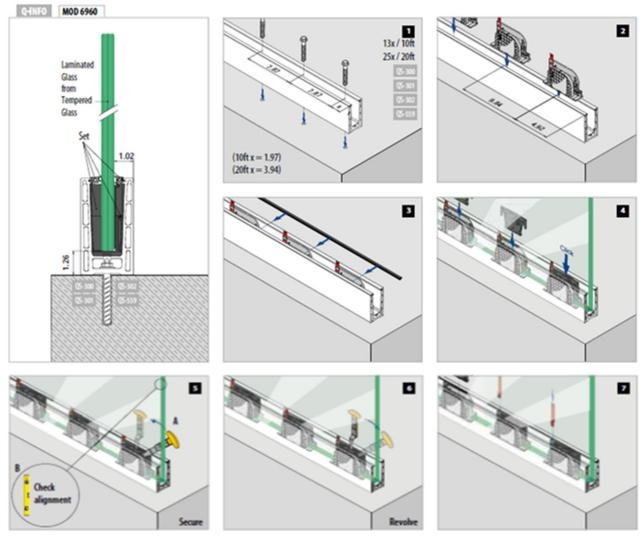
FIGURE 3—GUARD RAIL ASSEMBLY COMPONENTS (Q-DISK SYSTEM)
