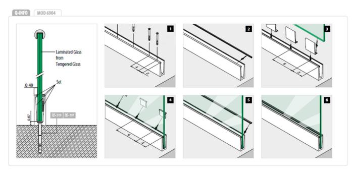
FIGURE 2—GUARD RAIL ASSEMBLY COMPONENTS (WEDGE SYSTEM)
